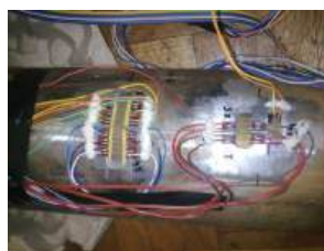
Eksp. ispitivanje cevi sa površinskom prslinom
