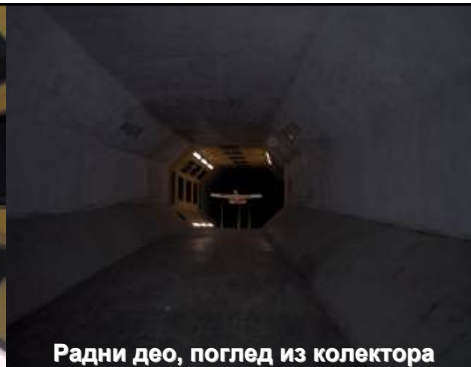
Модел аеротунела AT-SB-1 Машинског факултета
